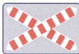
Signal 31 Signalisation de position, d'une part, des passages à niveau à une voie sans barrières ni demi barrières et non munis de signalisation automatique et, d'autre part, des aires de danger aérien où les mouvements d'avions à basse altitude constituent un danger pour la circulation routière
