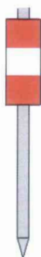
913 (exemple) Piquet : signalisation de position des limites d'obstacles temporaires ou de chantier
