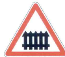
123 Passage à niveau muni de barrières à fonctionnement manuel lors du passage des trains
