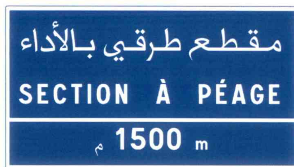
470 Présignalisation du début d'une section routière ou autoroutière à péage. L'usager ne désirant pas s'engager sur la section routière ou autoroutière à péage peut changer de direction à l'intersection suivante
