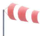
Balise 17 Manche à air, Balise indiquant l'endroit où souffle fréquemment un vent latéral violent ainsi que l'intensité et la direction de celui-ci
